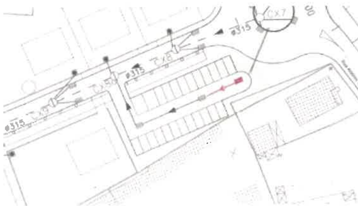
Acrescento de coletor e sarjeta no estacionamento do novo arruamento
